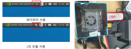
그림 8. LTE 모듈 사용 예시 Fig. 8. Example of LTE module usage
